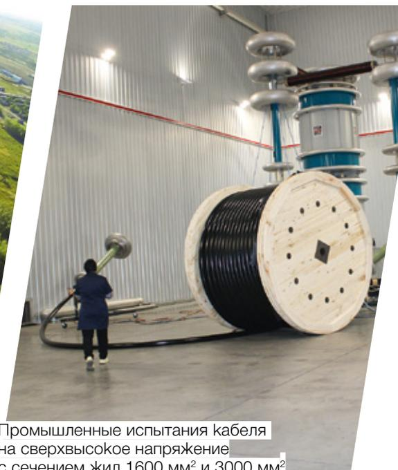
Промышленные испытания кабеля на сверхвысокое напряжение с сечением жил 1600 мм<sup>2</sup> и 3000 мм<sup>2</sup>
