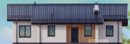
Все вариации проекта объединяет простой и экономичный конструктив: фундамент — монолитная ж/б плита, стены — двойной керамический кирпич, кровля — металлочерепица.
