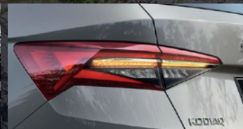
Задние светодиодные фонари с динамическими указателями поворота
